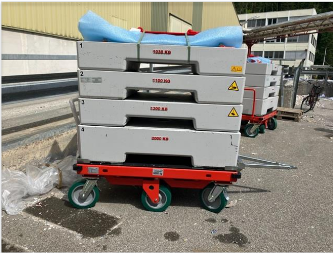
X-Move mit 6 t Zuladung im industriellen Einsatz
