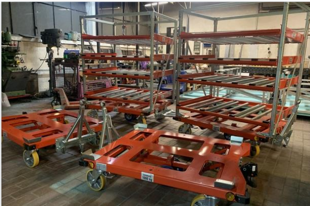
Gekoppelte Routenzuglösung mit 1000 kg Plattformen
